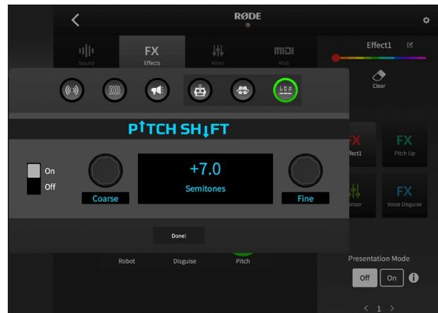
Mithilfe der beiden Regler auf der rechten Seite des Menüs stellst du den Bereich des Pitch Shifts ein, der maximal eine Oktave (12 Halbtöne) über oder unter dem Eingangssignal liegen kann.
