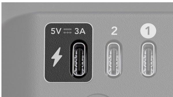
Du kannst das Streamer X auch von deinem Computer aus mit Strom versorgen. Verbinde zu diesem Zweck den USB 1 Port über das mitgelieferte USB-C Kabel mit dem USB-C Anschluss deines Computers.
